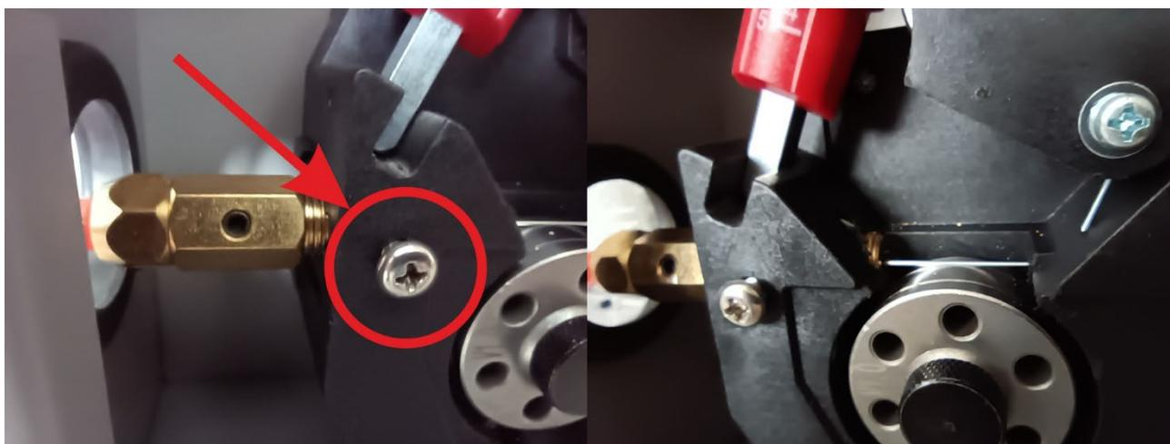
**Figura 7.7.1 Inserimento tubo di alimentazione filo e vite di fissaggio**
