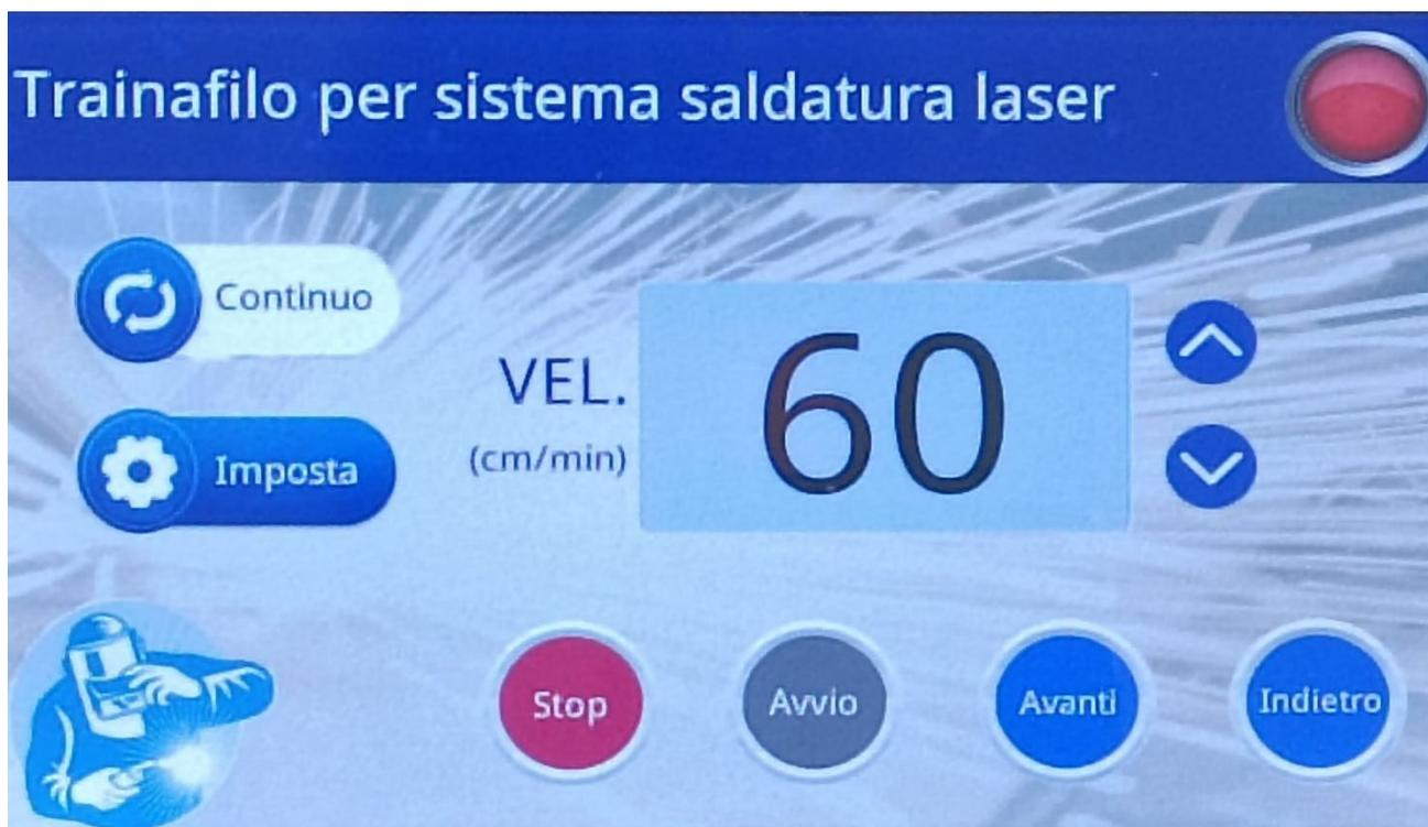
Figura 7.8.1 Pagina principale del pannello di controllo in modalità CONTINUO
