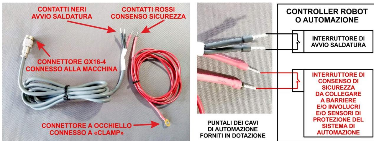
Figura 10.2 Collegamento dei cavi di automazione
