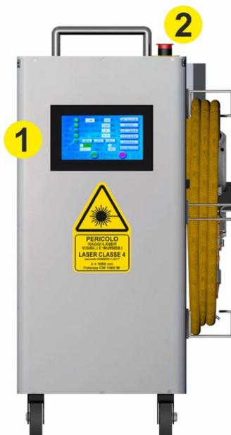
Figura 4.1 Il pannello frontale del laser a fibra FCA 1500
