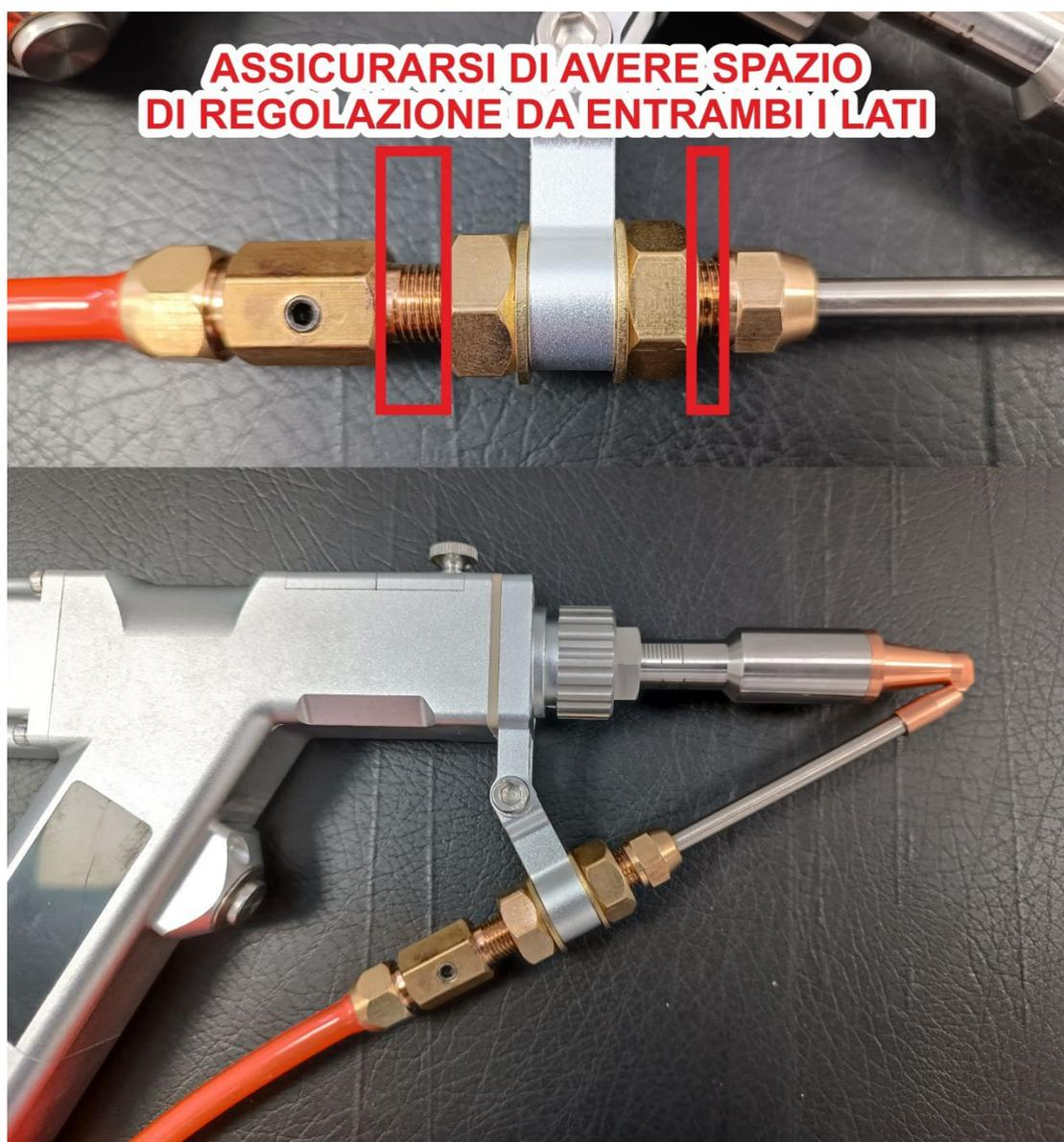
Figura 7.7.3 Montaggio corretto del tubo sulla pistola
