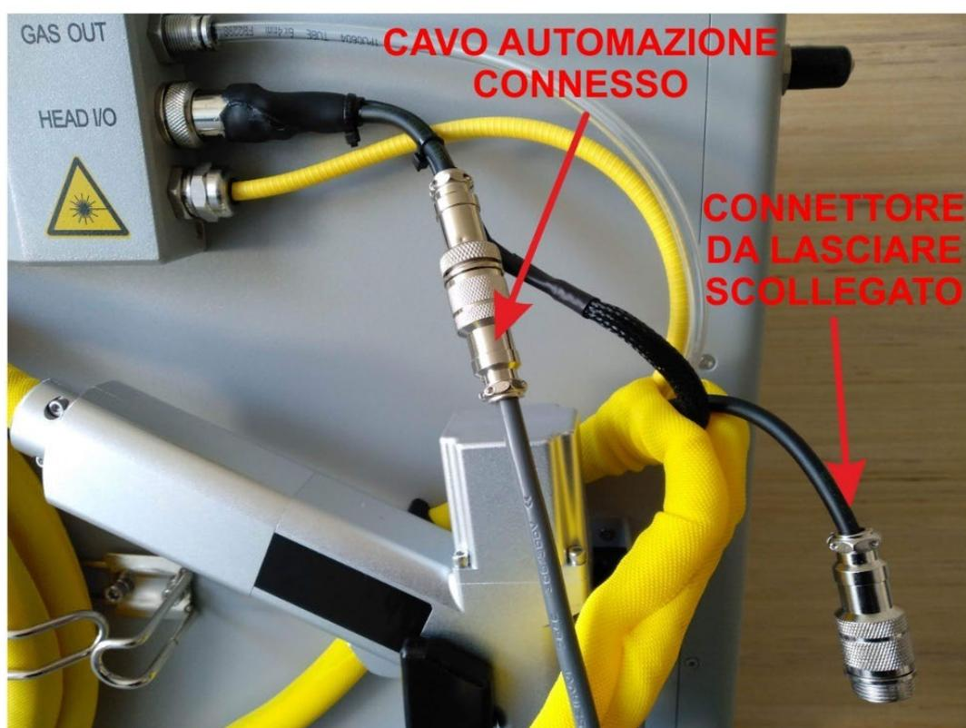
**Figura 10.1.2 Collegamento cavo di automazione alla macchina**
