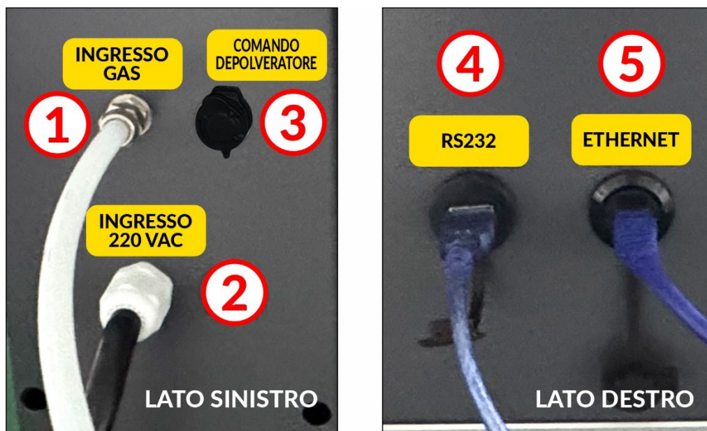
Figura 4.2 Le connessioni posteriori del laser a fibra CITA 2030
