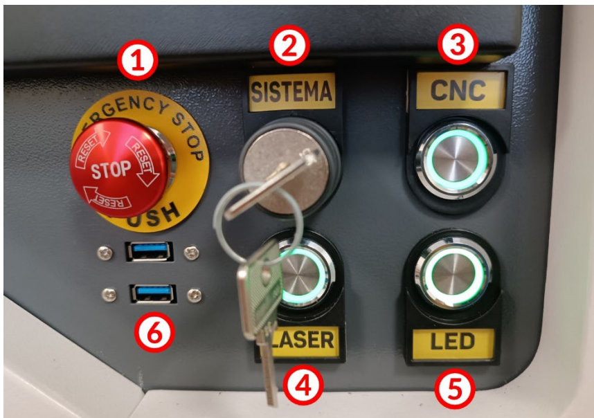
Figura 4.1 Il pannello frontale del laser a fibra CITA 2030
